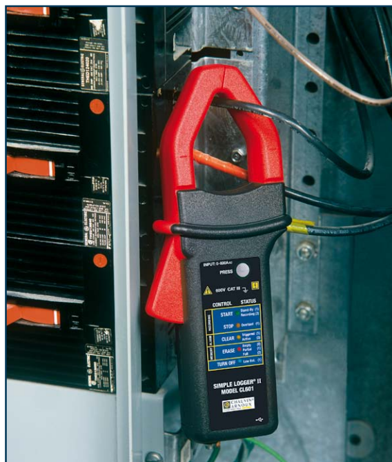
Einfache Erfassung des Stroms an einer Schalttafel
