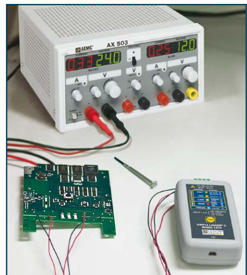
Datenaufzeichnung an zwei DC-Spannungsquellen mit dem Modell L432
